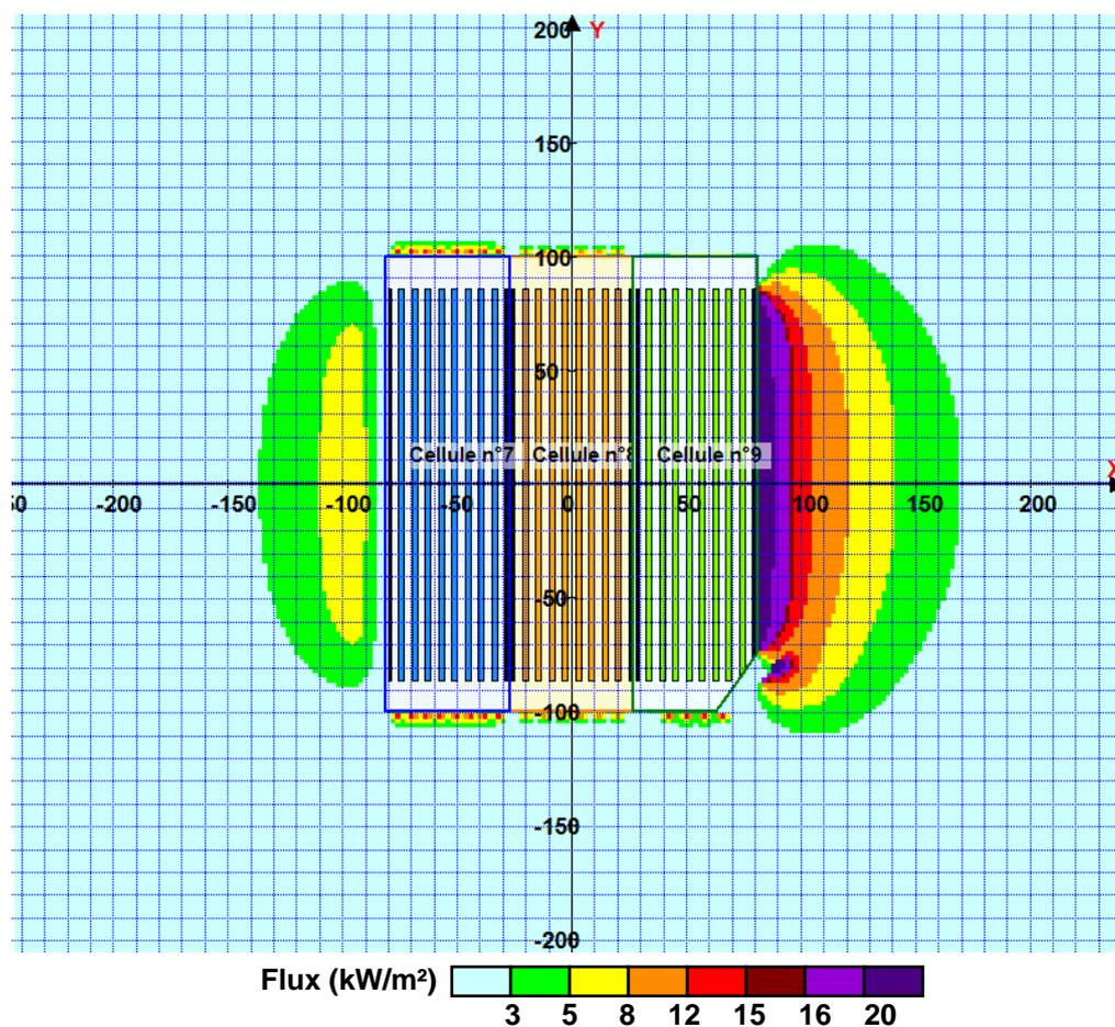
**Avertissement:** Dans le cas d'un scénario de propagation, l'interfacé de calcul Flumilog ne vérifie pas la cohérence entre les saisies des caractéristiques des parois de chaque cellule et la saisie de tenue au feu des parois séparatives indiquée en page 2 de la note de calcul.
